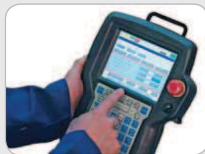
Controle robótico suspenso exibindo a interface do KempArc Browser.
