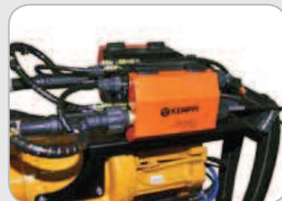
Os alimentadores de arame DT 400 são equipados com o confiável mecanismo de alimentação de arame de 4 rolos DuraTorque e rolos de alimentação totalmente em metal com excelente resistência ao desgaste.
