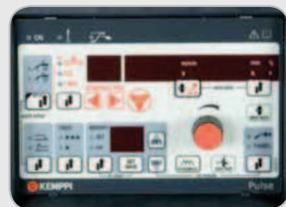
Painel de controle Kempact Pulse 3000
